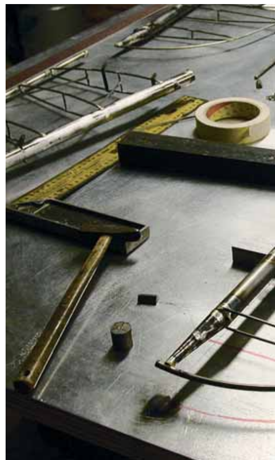
Nelle foto sopra e sotto: costruzione dei piani di coda in tubo di acciaio.
