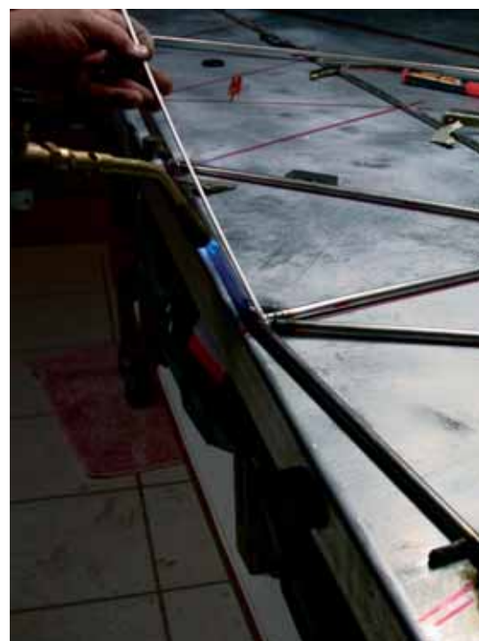
Sopra: fase iniziale della costruzione della fusoliera. La prima fiancata viene saldata deguendo il disegno tracciato sul banco in lamiera. I tubi sono tenuti in posizione da calamite.
