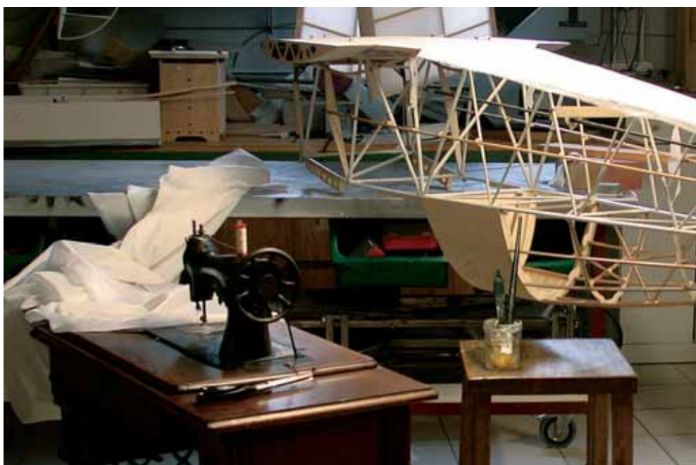
A fianco: per la ricopertura della fusoliera ho dovuto anche improvvisarmi sarto per applicare al tessuto le cerniere di ispezione dei leverismi di coda.
